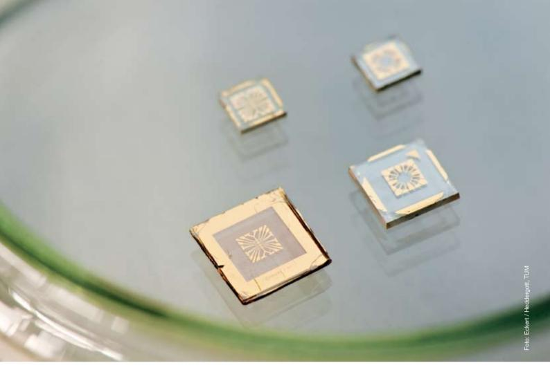
**Grundlage für derartige Biochips** sind flache, extra zu diesem Zweck hergestellte Industriediamanten. Die hauchdünnen, durchsichtigen Einkristalle, meist fünf mal fünf Millimeter groß und nur einen halben Millimeter dick, sind wegen ihrer enormen Reinheit sehr wertvoll
