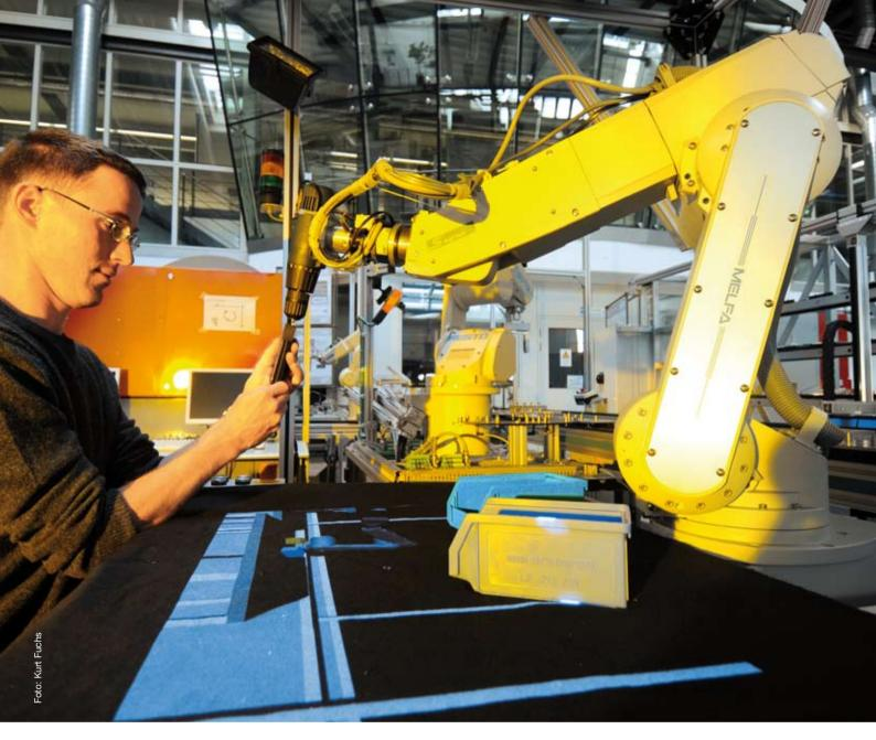
Besser als eine Maschine kann der Mensch Kabel und Lämpchen in das Labyrinth einbauen. Der Roboter hat hier nur die Rolle des Assistenten, er hält den Akkuschrauber
