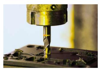
Die Werkzeugmaschine bohrt die Gänge des Labyrinths in den Kunststoff
