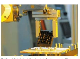
Fertig gefräste Labyrinthe nimmt ein Greifarm aus der Werkzeugmaschine und setzt sie auf ein Förderband Richtung Montage
