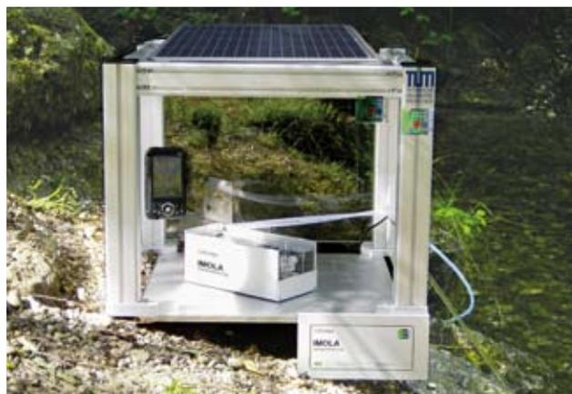
**Solarzellen versorgen das Wasserüberwachungsgerät mit Energie, die Daten werden per Mobiltelefon übermittelt**
