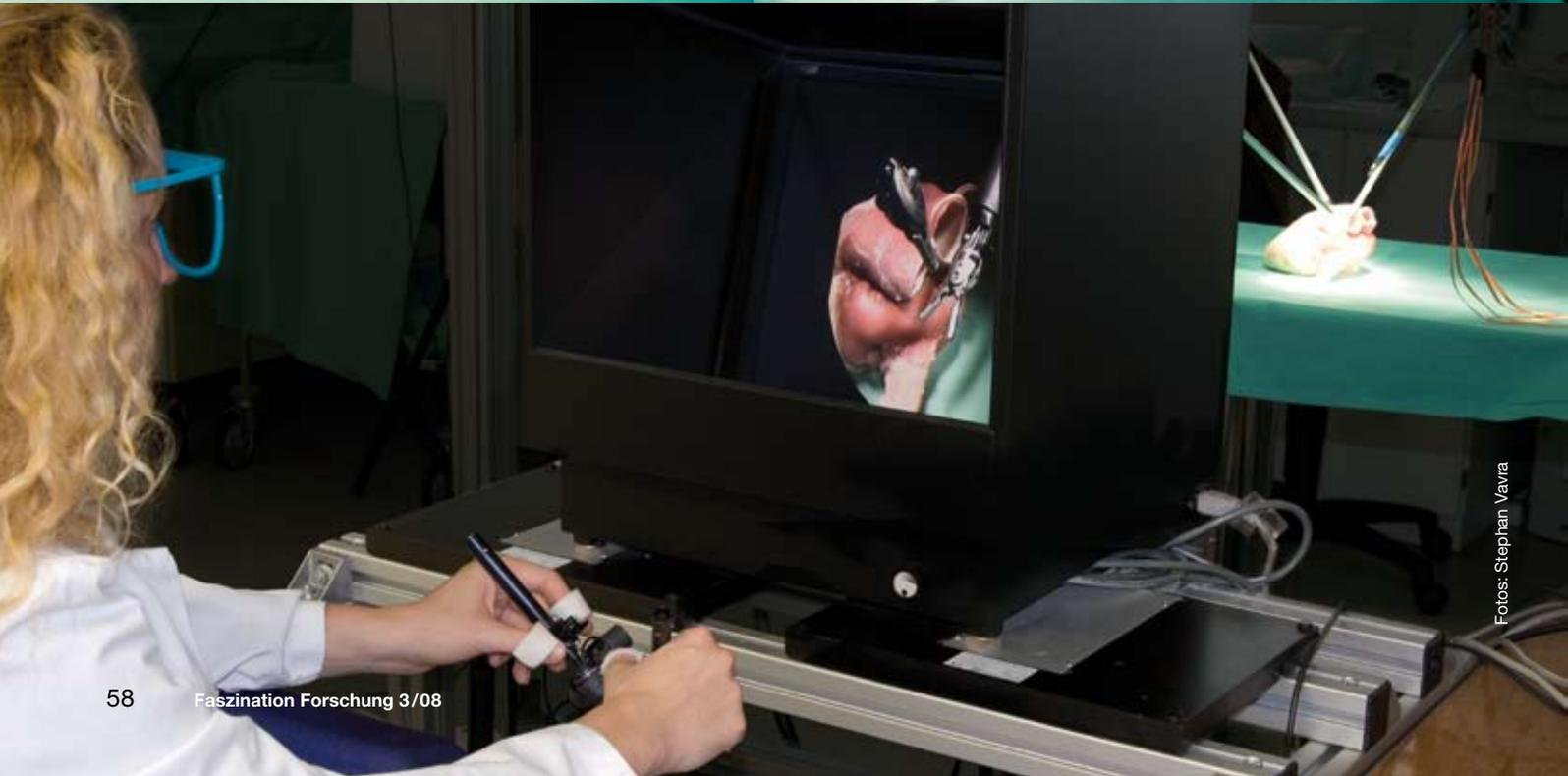
**Die Roboterarme des chirurgischen Telemanipulators**, der mit Tastsinn ausgestattet ist, werden über zwei Bedienelemente gesteuert. Der Monitor gewährt den Operateuren 3D-Blick auf den OP-Situs – hier ein „Patientenmodell“. Der Operationsroboter ist eine Entwicklung des Deutschen Herzzentrums München mit dem Lehrstuhl Robotics and Embedded Systems der TUM im Rahmen des Sonderforschungsbereiches 453
